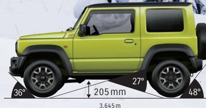
Die **kurzen Überhänge** sorgen für Böschungswinkel von 36 Grad vorne und 48 Grad hinten, der Rampenwinkel beträgt 27 Grad. Die Bodenfreiheit von 205mm unterstreicht die kompetenten Offroad-Qualitäten. Durch den kurzen Radstand (2250mm) bleibt der Jimny wendig.
