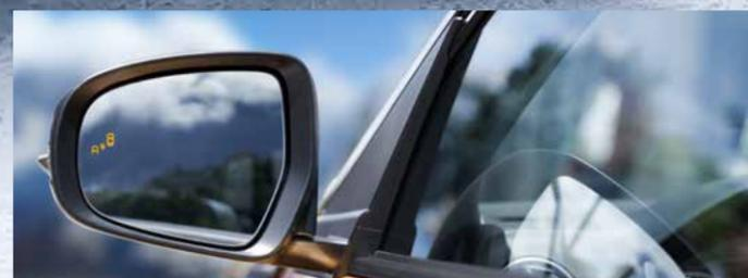
**Neuste Assistenzsysteme:** Wenn sich ein Fahrzeug im toten Winkel befindet bzw. sich diesem nähert, schaltet sich die Warnleuchte im betreffenden Aussenspiegel ein.
