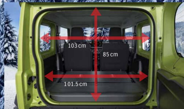
Die Rücksitze sind **einzel** umlegbar und geben eine völlig ebene Ladefläche frei (nur bei Compact Top), die für alle Fälle mit robustem Noppenkunststoff bezogen ist. So lässt sich der Laderaum vielfältig nutzen und bis zu einem Maximalvolumen von 377 Litern vergrößern.
